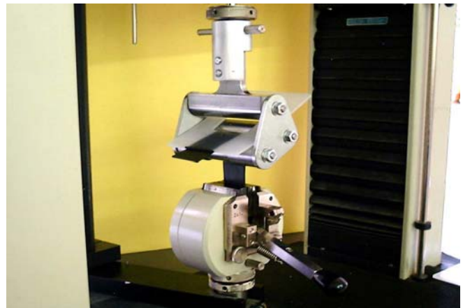
TPE-Schältest für 2K-Verbundhaftung gemäß DIN EN 1464
