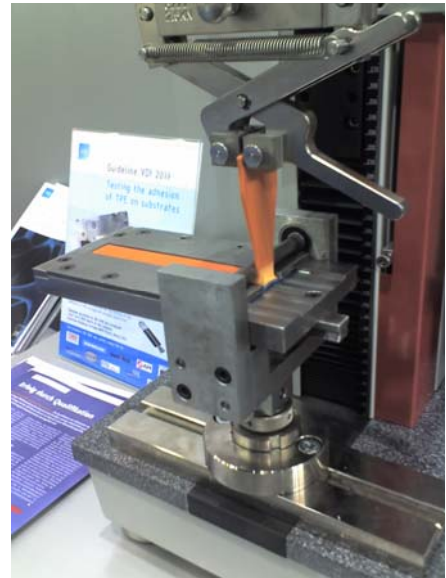
VDI 2019 Schälvorrichtung / K 2010
